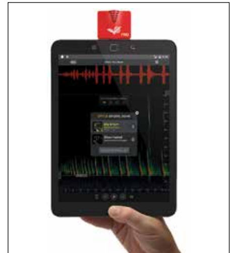
Der Echo Meter Touch ermöglicht in Verbindung mit Smartphone oder Tablet-PC Echtzeitaufnahmen. © Wildlife Acoustics
