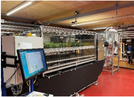
Abbildung 107: Prototyp des Trockners im Labor, Foto: Natalie Rotter /AEE INTEC
