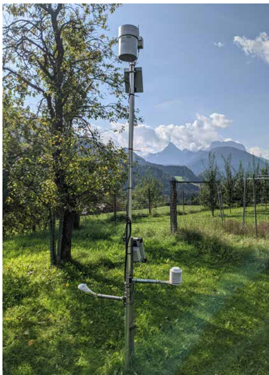
Mithilfe der Adcon-Wetterstationen wurden die wesentlichen Klimaparameter auf den drei Standorten in der Steiermark gemessen.
